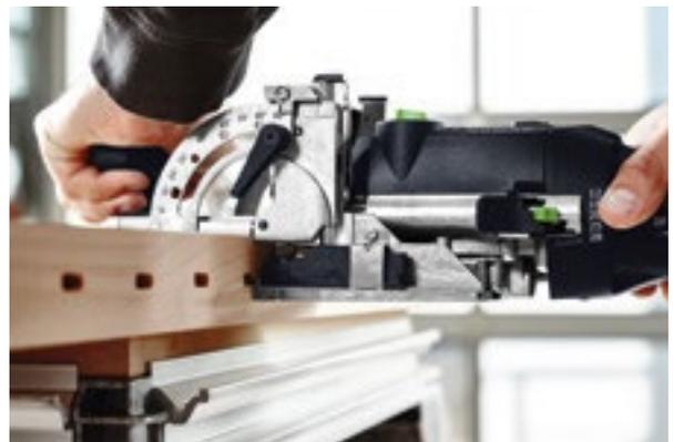
Stellen Sie die Fräshöhe auf die Werkstückmitte ein. Zeichnen Sie auf der Werkstückoberseite den Achsabstand der Leisten an. In diesem Fall (wenn mit einfachem Anzeichnen gearbeitet wird) bringen Sie die Skala im Sichtfenster der DOMINO deckend über den Anriss und setzen die Fräslöcher. Ein doppelter Anriss wie im Beispiel des Handlaufes oben ist hier also nicht notwendig.
