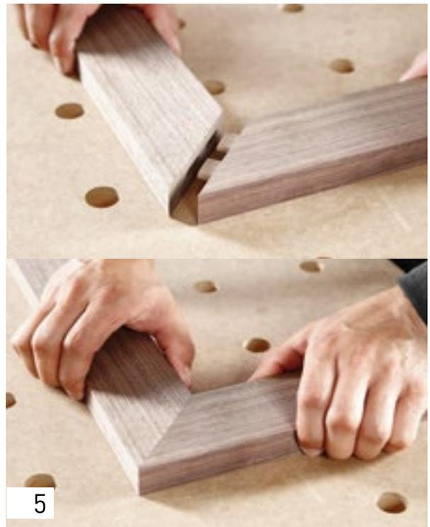
Setzen Sie die Dübel unter Verwendung von ausreichend Leim ein, setzen Sie die Rahmenfriese zusammen und verspannen Sie diese beispielsweise mit Zwingen.
