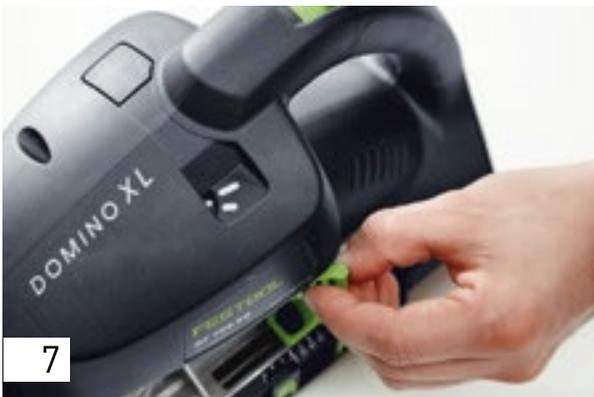
Stellen Sie für die Querlöcher die Maschine auf die große Lochbreite um; so finden die Queranker mit den darumgeclipsten Verbreiterungsclips Platz.
