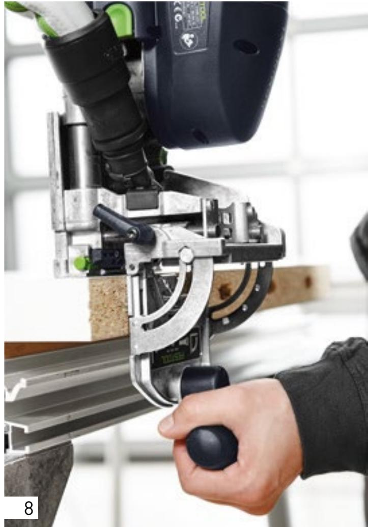
Fräsen Sie nun mit der Frästiefe von 30 mm (dieses Maß ergibt sich individuell je nach Werkstück. Wichtig ist, dass das Querloch das Längsloch um 5 mm in der Tiefe überschneidet. Falls Sie die Queranker ohne Verbreiterungsclips einsetzen genügt eine Überschneidung von 3 mm) und einer Fräshöhe von 40 mm (diese ist für jeden Verbinder identisch, denn sie begründet sich durch die Länge des Verbinders) Querlöcher dort in beide Werkstücke, wo die Flächenverbinder eingesetzt werden sollen.
