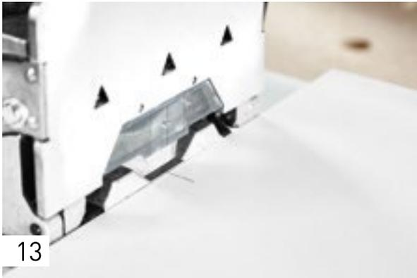
Die weiteren Löcher setzen Sie mithilfe der Skala im Sichtfenster, die Sie an den Anrissen ausrichten. Setzen Sie hier in der Plattenkante alle Löcher mit der schmalen Lochbreite – dort werden die Dübel zuerst eingeleimt und sitzen dann ganz exakt.
