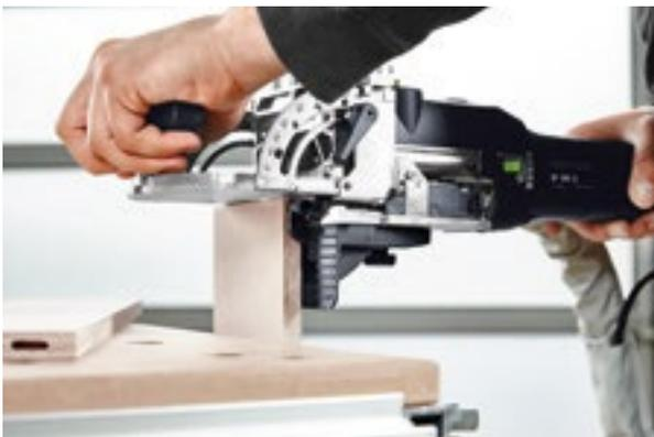
**HINWEIS** Selbstverständlich sind auch stumpfe Verbindungen mit dem kleinsten DOMINO Dübel möglich. Gehen Sie dabei wie oben beschrieben vor und fräsen Sie die Dübellöcher mit Hilfe des Zusatzanschlages stirnseitig ein.
