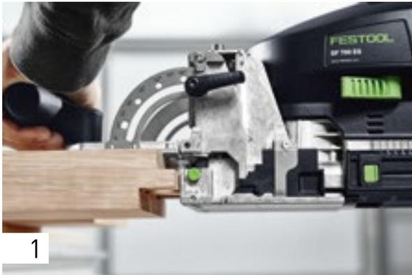
Zeichnen Sie die gewünschte Position der Dübel an und arbeiten Sie mithilfe des Sichtfensters. Fräsen Sie in beide Werkstückteile mit der maximalen Frästiefe (jeweils 70 mm) mit dem 14-mm-Fräser.
