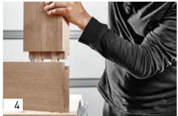
Schlagen Sie dann die Dübel bis zum Anschlag unter Zugabe von Leim in die Fräslöcher im Hirnholz ein.
