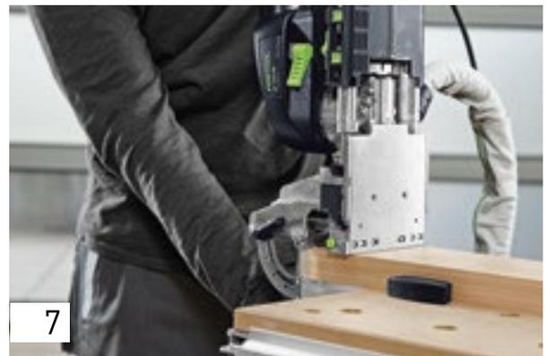
Fräsen Sie nun das Querloch dort in die Zarge, wo der Verbindereingesetzt werden soll. Dafür legen Sie die Klappe vorne an der Werkstückkante an und richten die Maschine am Anriss oder über die Anschlagpins aus (je nachdem, auf welche Weise das waagrechte Fräsloch gesetzt wurde).
