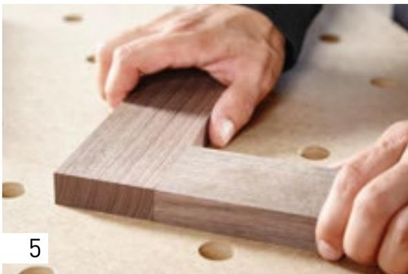
Verleimen Sie nun die Rahmenfrieze und spannen Sie diese ggf. mit Zulagen und Zwingen.
