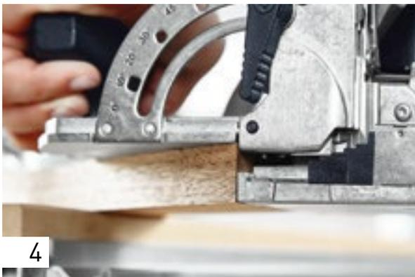
Für das zweite Fräsloch zeichnen Sie entweder die Position an oder Sie fahren mit der Maschine außen bündig an die Spitze der Gehrung. Dieses Fräsloch können Sie entweder wie das erste Loch passgenau fräsen – dies erhöht die Stabilität der Verbindung, erfordert aber auch genaueres Arbeiten. Oder Sie fräsen das zweite Loch mit Spiel, müssen dann aber ausreichend Leim für die Verbindung verwenden.
