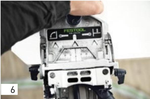
Fräsen Sie nun in beide Werkstücke an den Markierungen die 50 mm tiefen Fräslöcher mit der schmalen Lochbreite ein. Aufgelegt wird hierbei auf der Plattenoberseite.
