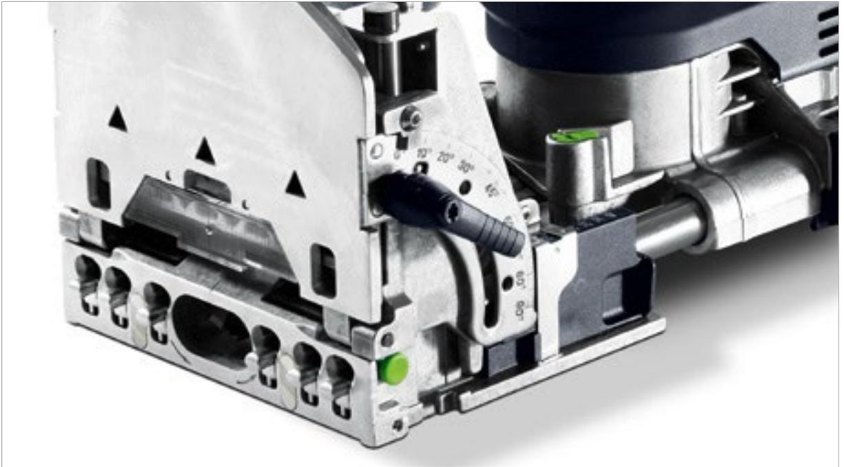
Die **DF 700** verfügt über ein innovatives Anschlagssystem, bei dem mit den integrierten Anschlagpins auch Dübelgruppen ausgehend von einer Bezugskante schnell und präzise positioniert werden können.
