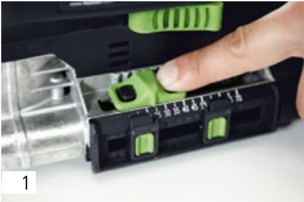
Stellen Sie die Frästiefe der Dübelfräse auf 25 mm ein – setzen Sie dabei die Marker auf 25 mm und 50 mm.
