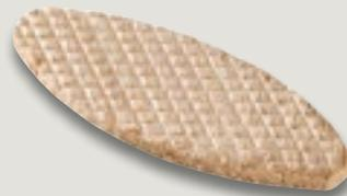
Flachdübel werden schnell – und meist mit Handmaschinen – nach Anriss positioniert. Da die Flachdübel kürzer sind als die gefrästen Schlitz, ist ein leichter Versatz beim Einfräsen kein Problem. Die Verbindung ist verschiebbar. Allerdings verlangt dieser Vorteil ein zusätzliches Ausrichten beim Verleimen.
