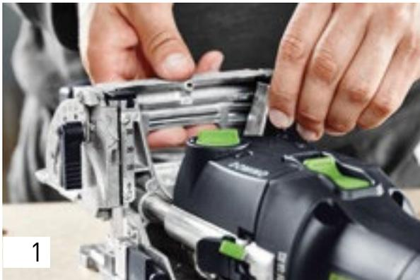
Stellen Sie die Fräshöhe analog der Dicke Ihres Werkstückes ein, als Frästiefe wählen Sie die halbe Dübellänge. Die Fräslöcher fräsen Sie entweder beide mit der passenden Lochbreite für äußerste Passgenauigkeit; alternativ können Sie auch schon das zweite Dübelloch mit Spiel setzen.
