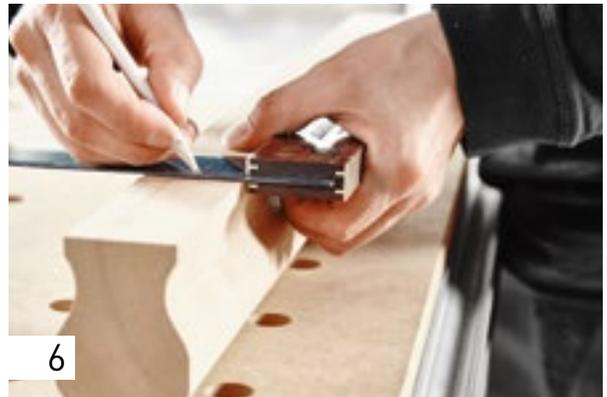
In diesen Fällen hilft ebenfalls der Leistenanschlag weiter: Zeichnen Sie die gewünschte Position der Leisten am Handlauf an, dort wo später die Fräsung sein soll. Von dieser Markierung setzen Sie eine weitere Markierung 10 mm entfernt (bei Verwendung der DF 700 sind es 15 mm) – daran legen Sie später an. Stellen Sie nun den Fräswinkel auf 90°, so können Sie senkrecht von oben in den Handlauf fräsen. Die Frästiefe beträgt beim zu verarbeitenden 6 x 40 mm Dübel wie bei den Leisten wieder 20 mm.
