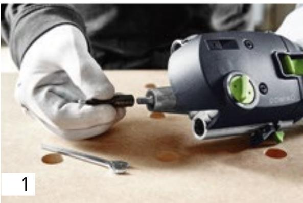
Vor Beginn der Arbeit stellen Sie sicher, dass der korrekte Fräser eingesetzt ist. Im vorliegenden Beispiel verarbeiten wir einen Dübel der Größe 8 x 40 mm; somit muss der 8 mm Fräser eingesetzt sein.
