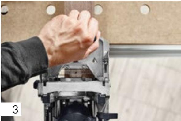
Das zweite Fräsloch wird hier mithilfe der Anschlagklinke gesetzt. Durch dieses Vorgehen ist es möglich, zwei Dübel nebeneinander – ausgehend von nur einer Bezugskante – zu positionieren.
