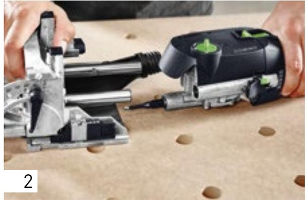
Motoreinheit und Führungsgestell voneinander lösen.
