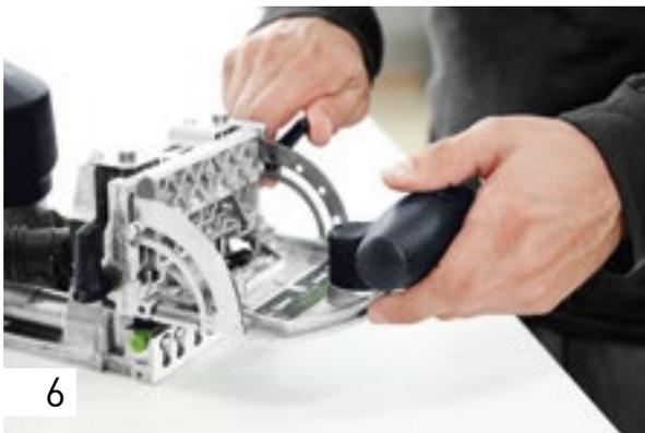
Das Klappenmaß, also die Einstellung der Fräshöhe, ist in jedem Fall bei 40 mm einzustellen. So sitzt das Querloch immer im richtigen Abstand zur Werkstückkante und es ist sichergestellt, dass der Ankerbolzen anschließend im Queranker greift.
