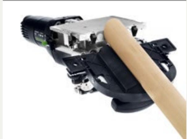
Holz-Rundstäbe von  $\varnothing$  35–60 mm sind bereits mit einem DOMINO Dübel verdrehsicher fixiert: einfach Rundanschlag aufstecken, feinjustieren, das Werkstück anlegen und fräsen.
