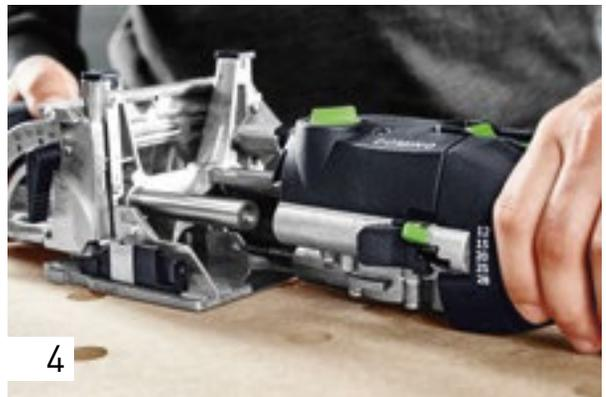
Stellen Sie vor dem Einsetzen eines neuen Fräasers sicher, dass die Maschine, das Führungsgestell und die Führungen sauber und frei von Spänen sind. Beseitigen Sie evtl. Verschmutzungen. Setzen Sie nur scharfe, unbeschädigte und saubere Fräswerkzeuge ein. Nun das Führungsgestell bis zum hörbaren Einrasten auf die Motoreinheit schieben.
