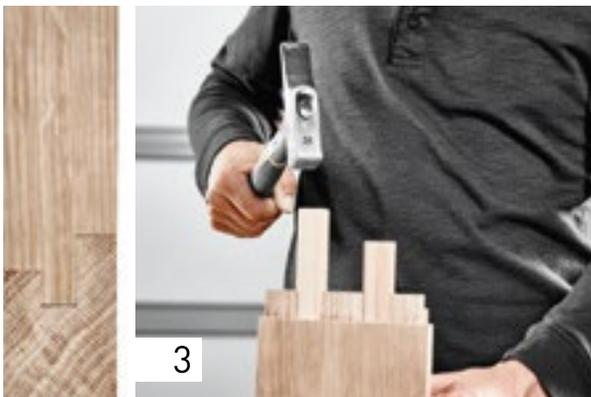
Schneiden Sie nun die Dübel passend von der Stangenware zu. Im vorliegenden Beispiel beträgt die Dübelnennlänge 115 mm: Diese ergibt sich aus  $2 \times$  der Frästiefe von 70 mm = 140 mm abzüglich der Konterverbindung von 25 mm = 115 mm. Schneiden Sie den Dübel einige Millimeter kürzer (damit später der Leim ausreichend Platz findet) also 112 mm. Fasen Sie den Dübelzuschnitt an den Kanten mit einem Schleifklotz etwas an.
