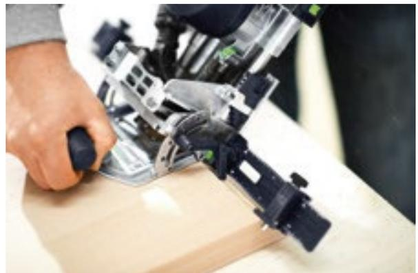
**TIPP** Für größere Lochabstände können Sie sowohl bei der DF 500 als auch bei der DF 700 mit dem Queranschlag (als Zubehör erhältlich bzw. bei der DF 500 in der Setversion im Lieferumfang enthalten) arbeiten.
