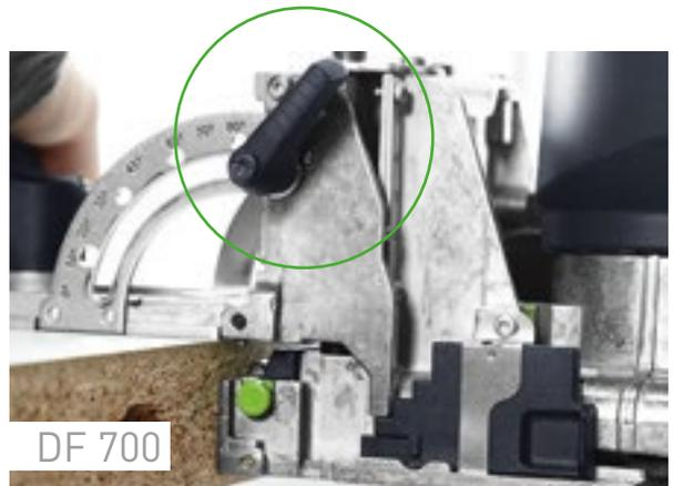
**DF 700:** Die Einstellung der Fräshöhe bei der DF 700 erfolgt analog zur DF 500. Einzig zu beachtender Unterschied: Die Höhe der Vorwahleinstellung bezeichnet hier nicht die Plattendicke, sondern den tatsächlichen Abstand von der Oberseite des Werkstückes bis zur Mitte des Fräsloches.
