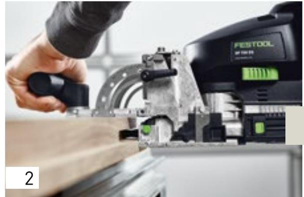
Im Längsfries setzen Sie die Fräslöcher ebenfalls mit 70 mm Frästiefe, setzen dabei aber das erste Loch passend, das zweite Loch als Langloch mit Spiel. Gehen Sie für die weiteren Längs- und Quersfriese ebenso vor.
