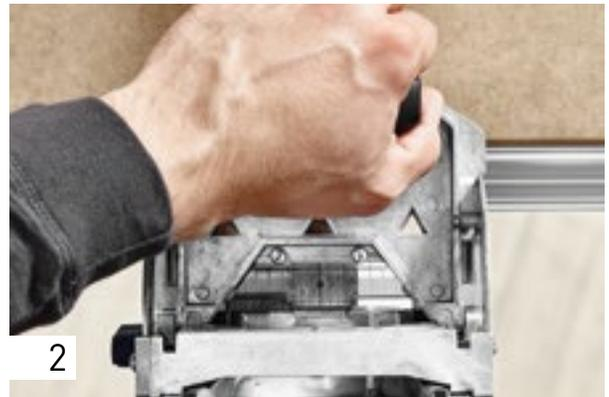
Die Fräslöcher können außer über das bereits bekannte Anzeichensystem auch mithilfe der Skala im Sichtfenster gesetzt werden – in unserem Fall 15 mm vom äußeren Rand entfernt. Dafür legen Sie die Skala bei der 15-mm-Markierung am Rand des Werkstückes an.
