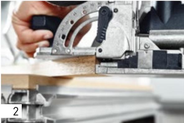
Die Fräshöhe wählen Sie entsprechend des Werkstückes; im vorliegenden Beispiel hat der Rahmen die Stärke von 20 mm. Stellen Sie daher an der DF 500 die Fräshöhe auf 20 mm ein. Die Breite des Rahmens beträgt im vorliegenden Beispiel 60 mm.
