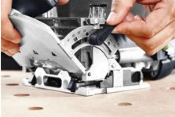
**DF 500 und DF 700:** Für die Einstellung des Fräswinkels lösen Sie den Klemmhebel für den Winkelanschlag. Stellen Sie dann den gewünschten Winkel ein, entweder anhand der Skala stufenlos von 0° – 90° oder rastend bei 0°, 22,5°, 45°, 67,5°, 90°. Schließen Sie den Klemmhebel.
