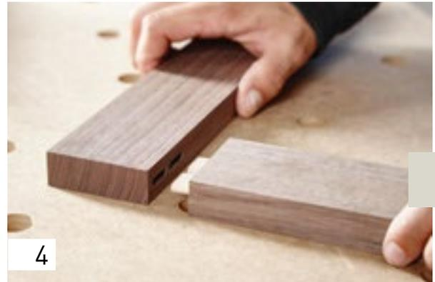
Führen Sie die Fräsungen analog diesem Vorgehen für alle vier Rahmenfrieze durch, wobei Sie bei je zwei der Rahmenfrieze dabei nicht in die Stirnseite, sondern längsseitig ins Werkstück fräsen.
