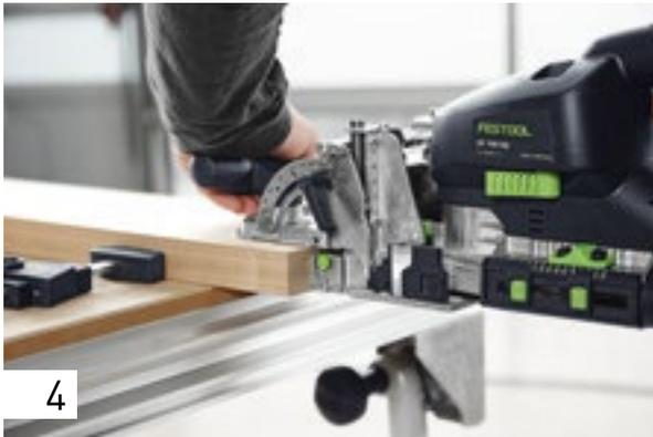
Stellen Sie die Frästiefe auf 50 mm um und fräsen Sie entsprechend des Anrisses oder über das Pin-Anschlagsystem die Fräslöcher (schmale Lochbreite) in die Zarge. Die Fräshöhe bestimmt sich individuell durch die Materialstärke; wie Sie es von der Arbeit mit Ihrer DOMINO DF 700 bereits gewohnt sind. Im vorliegenden Beispiel hat die Zarge die Materialstärke von 30 mm. Damit das Fräsloch mittig im Material sitzt, stellen Sie die Fräshöhe auf 15 mm ein.
