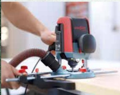
Schnelle und präzise Arbeitsfortschritte mit werkzeuglosem Fräserwechsel und Feineinstellung am Parallelanschlag.
