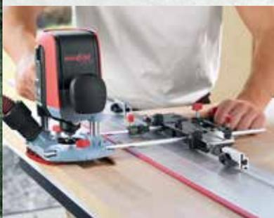
In Verbindung mit dem Oberfräsenadapter LO-FA kannst du z. B. Ausfräsungen für Griffmuscheln präzise und einfach umsetzen.
