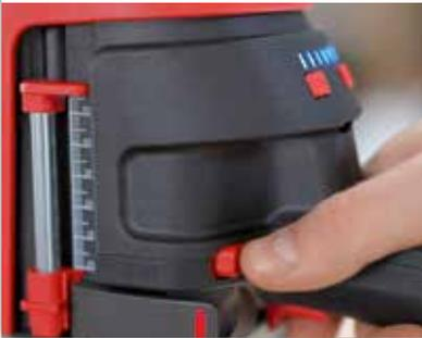
Indem du die Deboost-Taste betätigst, reduzierst du die Drehzahl mit nur einem Tastendruck um 30 %. Dadurch werden Brandspuren vermieden – beispielsweise beim Wechsel von Längs- auf Stirnholz.
