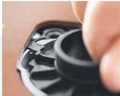
Beim Einsetzen wird der Kopier-ring automatisch durch die werkseitig kalibrierte Aufnahme zentriert. Dadurch entfällt das lange und mühsame Ausrichten.
