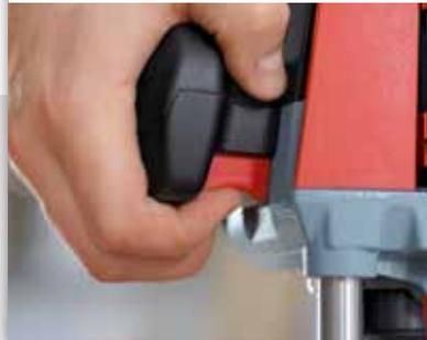
Die Frästiefe ist permanent geklemmt. Wenn du die Permafix-Taste betätigst, löst sich die Klemmung und du kannst die Frästiefe komfortabel einstellen.
